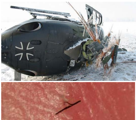
ヘリコプター墜落破損の際、CFRP の繊維が細かく飛び散り、皮膚に刺さる危険性も非常に高い
